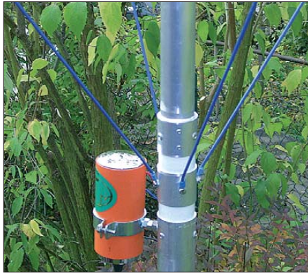
Bild 3: Hier ist der Anpassübertrager mit dem modifizierten Isolator und den Anschlüssen der Seitenstrahler zu erkennen.
