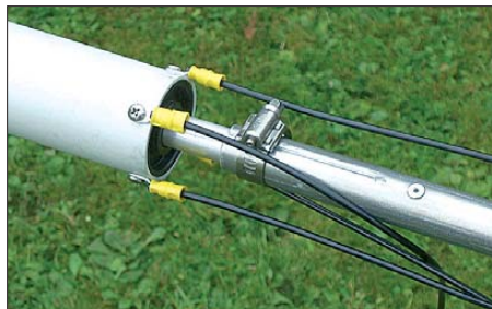
Bild 4: Befestigung der Seitenstrahler an der Ladespule
