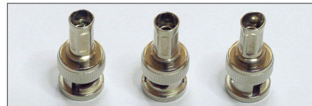
Bild 93: Fertiggestellte Kalibrierelemente mit Crimphülsen
