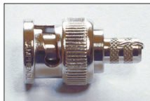
Bild 90: BNC-Stecker mit angelötetem Draht
