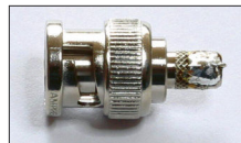
Bild 89: BNC-Stecker mit umgelegtem und gekürztem Draht
