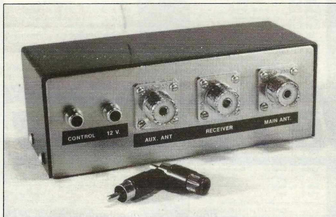
A l'arrière, les prises "antennes".
