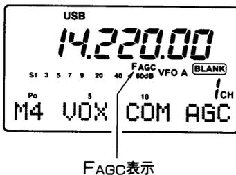
FM以外のモードで受信しているときに、AGC回路の動作を切り替えて使用できます。
