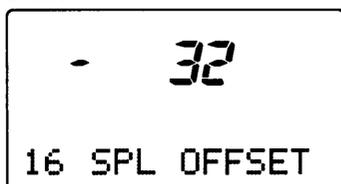
FM/WFM以外のモードでクイックスプリット機能操作時、表示していないVFOに設定する周波数は、あらかじめ±4000kHz(1kHzステップ)までのオフセット周波数を設定できます。
