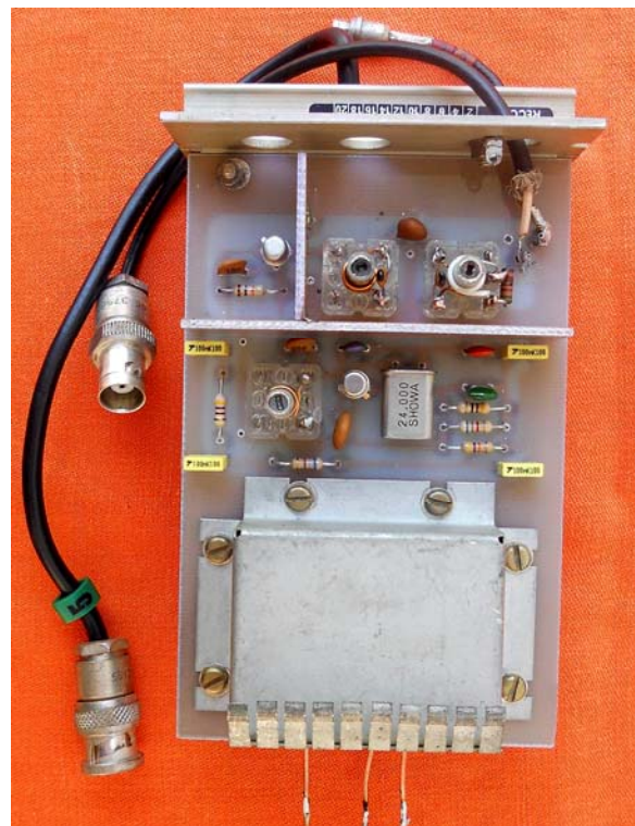
3) Foto del modulo 10 - Board "B" ricostruito
