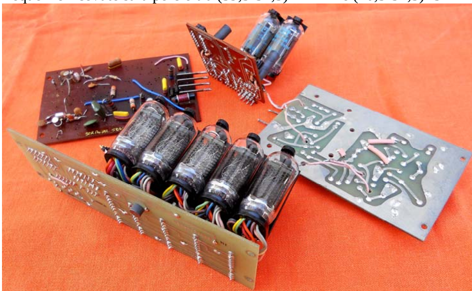
2a) Alcuni componenti deteriorati tolti dal ricevitore e sostituiti.
