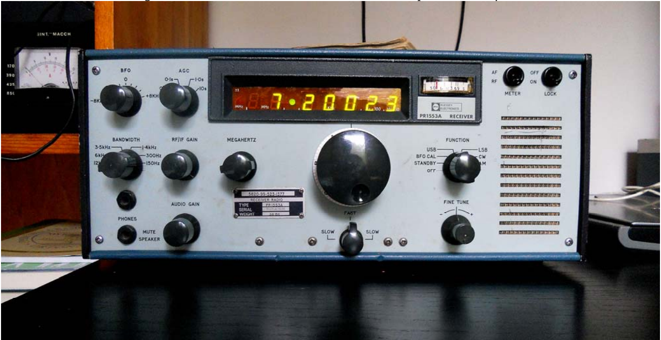
1) Foto del “PR1553A” modificato e funzionante con display a sette segmenti.
