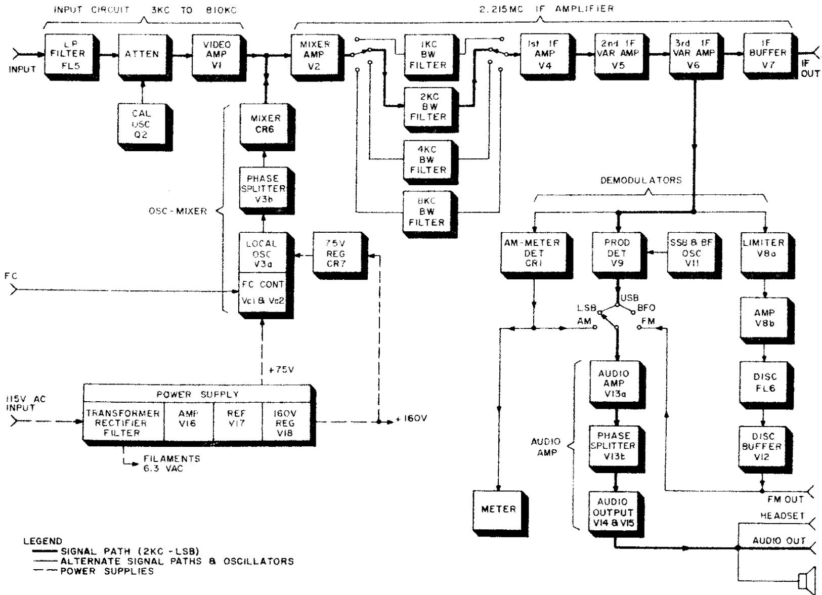
FIG. 1 BLOCK DIAGRAM, RI307A/GR RADIO RECEIVER
