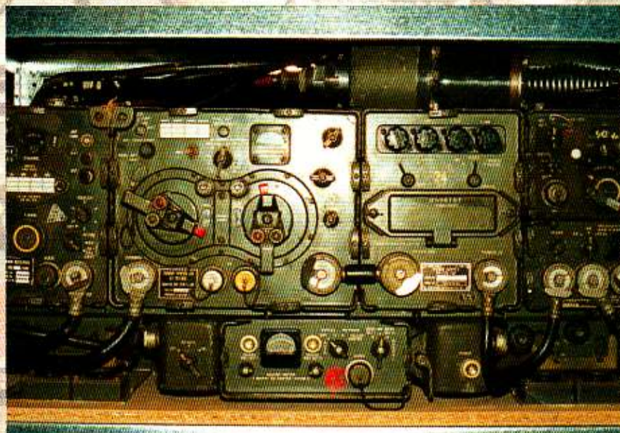
De RT-70 op mounting in combinatie met onder andere de RT-67, voeding PP-112 en hulpontvanger R-108.
