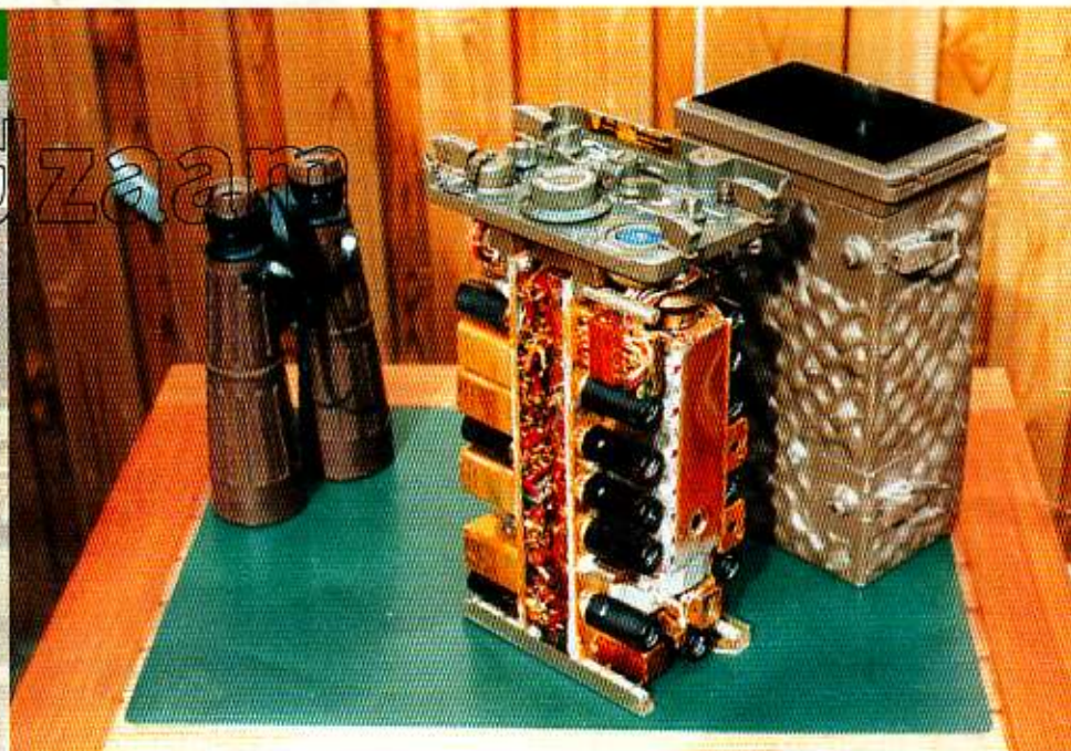
De legertransceiver RT-70 uit de behuizing.
