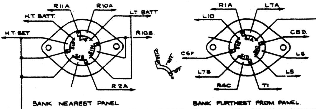
SEND/RECEIVE/OFF SWITCH, S1. REAR VIEW
