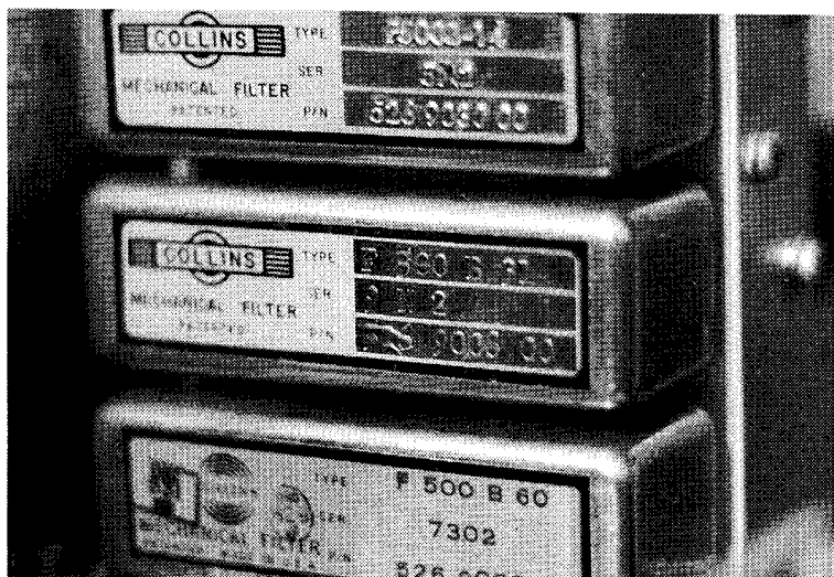
Foto 2 - Dettaglio dei filtri meccanici Collins.
