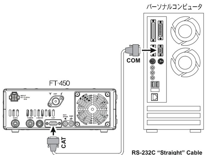
FT-450 の CAT 端子とパーソナルコンピュータの COM を RS-232C ストレート・フル結線ケーブルで接続します。
