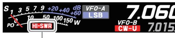
Это предупреждение о неисправности в антенной системе.
