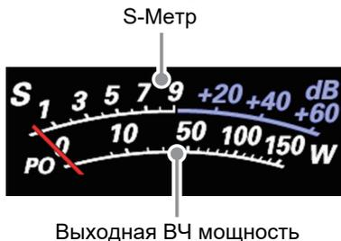
При касании экрана дисплея измерителя, отображается экран измерителя передачи (по умолчанию установлен измеритель "PO").
