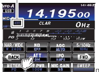
2. Для восстановления прежнего уровня сигнала коснитесь **[АТТ]** на ЖК-дисплее для восстановления индикации «OFF» в столбце АТТ на дисплее функций кнопок.
