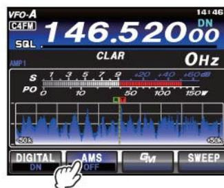
**VW (Режим FR):** Голосовые данные передаются в цифровом формате с использованием всего спектра 12.5 кГц. Возможна передача речевых сигналов высокого качества
