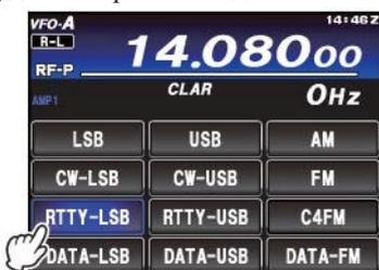
3. Нажмите кнопку **MENU(SETUP)**. Перечень пунктов меню будет отображен на дисплее. Вращайте регулятор **MULTI** для выбора пункта «072 DATA PORT SELECT». Коснитесь **[SELECT]** на ЖК-дисплее, а затем вращайте **MULTI** для установки значения «USB» в выбранном пункте меню. Коснитесь **[ENTER]** на ЖК-дисплее.
