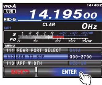
5. Нажмите кнопку **MENU** или коснитесь [**BACK**] на TFT дисплее для возврата к обычному режиму работы.
