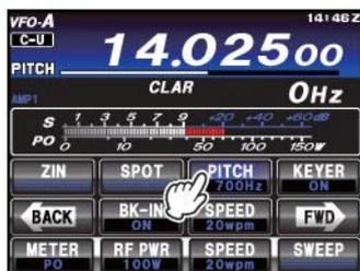
2. Вращайте **MULTI** для установки желаемого тона принимаемого CW (300 Гц - 1050 Гц).
