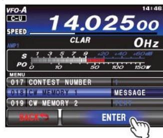
5. Нажмите кнопку **MENU(SETUP)** или коснитесь [**BACK**] на ЖК-дисплее для возврата к обычному режиму работы.
