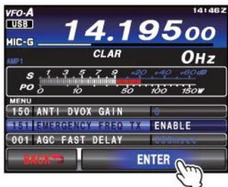
5. Нажмите кнопку **MENU(SETUP)** или коснитесь [**BACK**] на ЖК-дисплее для возврата к обычному режиму работы. Работа на передачу и прием на аварийной частоте теперь доступна.
