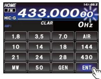
После завершения программирования домашнего канала новое значение рабочей частоты будет отображено на дисплее.
