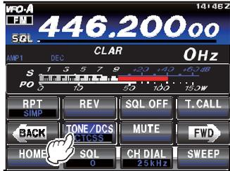
3. Коснитесь **[TONE/DCS]** несколько раз на ЖК-дисплее для выбора необходимого CTCSS режима. Если для доступа к репитеру требуется передача суб-тона, то выберите «ENC». Для использования кодера и декодера на входной и выходной частоте репитера, выберите «CTCSS». Допустимые значения:
