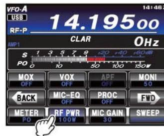
5. Для установки уровня микрофонного усиления соответствующего используемому микрофону и вашему голосу: Коснитесь [METER] несколько раз на ЖК-дисплее для выбора индикации «ALC». Теперь, нажмите и удерживайте тангенту **PTT** и говорите в микрофон с нормальным уровнем голоса.
