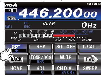
5. Коснитесь **[FWD]** для переключения экрана дисплея, а затем коснитесь **[TONE]**. Вращайте **MULTI** для выбора необходимого значения частоты CTCSS суб-тона. Вы можете использовать один из 50 стандартных CTCSS суб-тонов (смотри таблицу).
