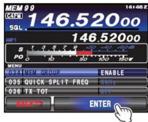
5. Нажмите кнопку **MENU(SETUP)** или коснитесь [**BACK**] на ЖК-дисплее для выхода. Использование каналов теперь будет ограничено шестью группами.
