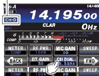
2. Коснитесь **[CH DIAL]** для выбора необходимого шага перестройки частоты. Касание **[CH DIAL]** приводит к смене значения шага в последовательности, представленной в таблице ниже
