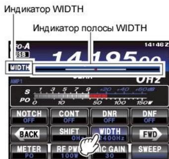
2. Вращайте регулятор **MULTI** против часовой стрелки для сужения полосы пропускания и уменьшения уровня помех.
