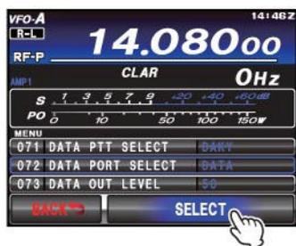
4. Вращайте регулятор **MULTI** для выбора пункта «060 PC KEYING». Коснитесь **[SELECT]** на ЖК-дисплее, а затем вращайте **MULTI** для установки значения «RTS» или «DTR» в выбранном пункте меню. Нажмите кнопку **MENU(SETUP)** или коснитесь **[BACK]** на ЖК-дисплее для возврата к обычному режиму работы.
