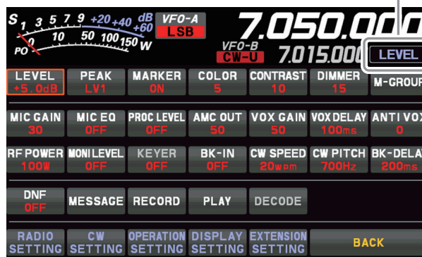
Funzionamento della manopola FUNC
